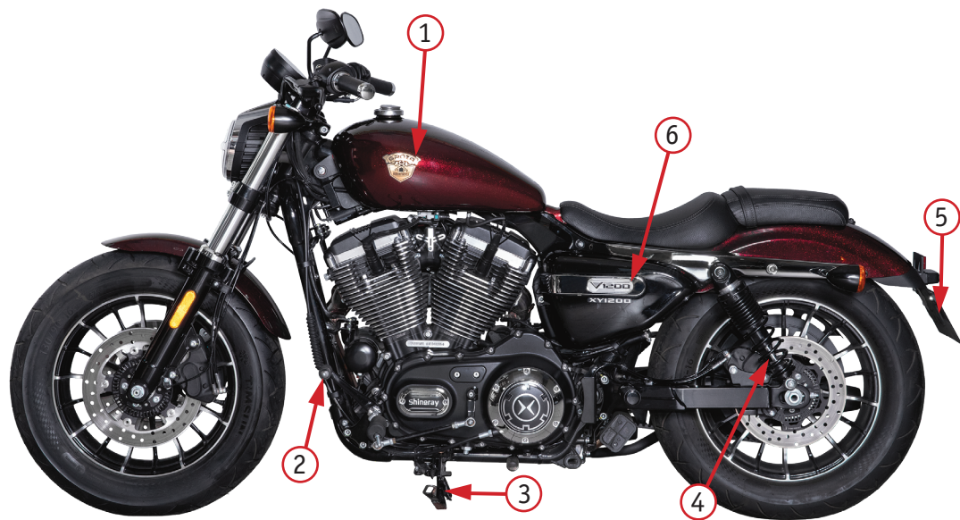
Фото 2.3. Вид слева: 1 – топливный бак; 2 – рычаг переключения передач; 3 – боковая подножка мотоцикла; 4 – задний амортизатор; 5 – крепление номерного знака; 6 – крышка аккумуляторного отсека
