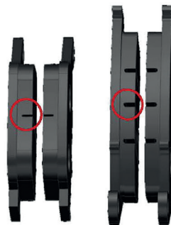
Фото 5.10. Определение износа тормозных колодок
