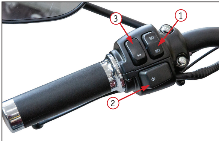
Фото 2.4 Левый комбинированный переключатель: 1 – кнопка переключения режима света фары (дальний свет/ближний свет); 2 – кнопка левого указателя поворота; 3 – кнопка звукового сигнала
