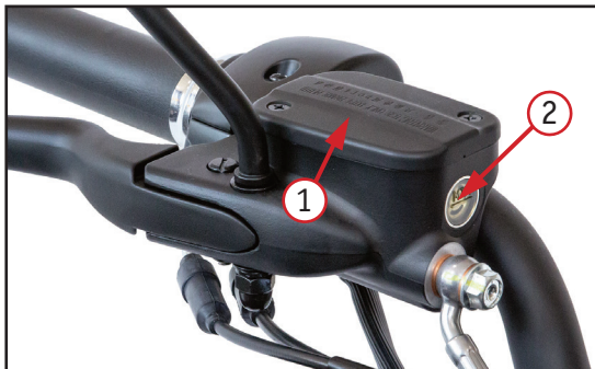
Фото 5.8 Уровень тормозной жидкости переднего тормоза: 1 –крышка; 2 – минимум
