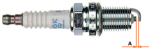
Фото 5.3. Зазор «А» между электродами свечи зажигания
